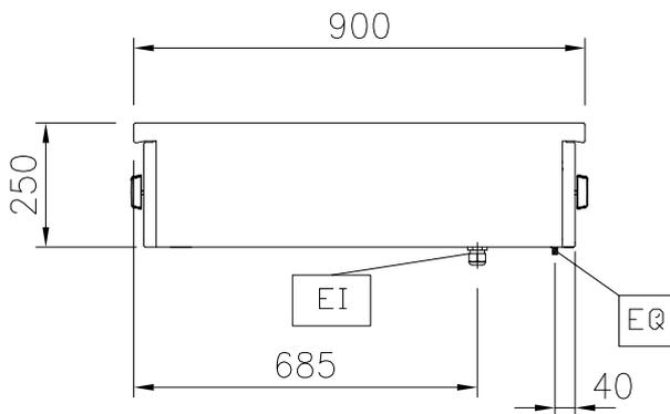
EI = Conexión eléctrica (energía)
